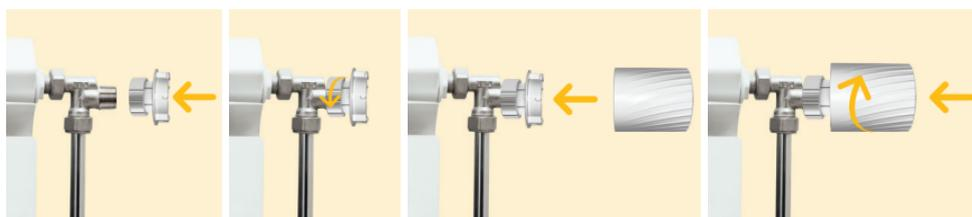
Figura 4. Esquema de montaje del cabezal termostático inteligente
